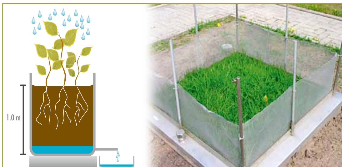
Figura 6: esquema y foto de un lisímetro (Tomado de Graham Reeves. Field Exposure & Effects Reg Labs, Milton Park, UK. Dow AgroSciences)
